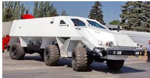
Рисунок 5 – Комплекс гуманітарного розмінування “Іскатель”
