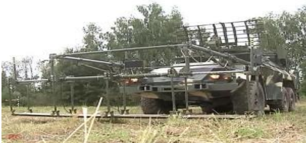
Рисунок 4 – Машина дистанційного розмінування “Ліства”
